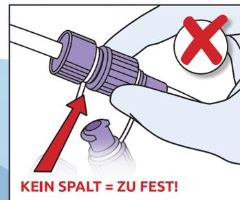
Verwenden Sie eine einfache „Zwei-Finger-Drehung“ für eine sichere und dichte Konnektion, indem Sie NUR den ENSwivel®-Drehring drehen.
