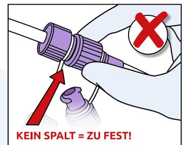
Verwenden Sie eine einfache „Zwei-Finger-Drehung“ für eine sichere und dichte Konnektion, indem Sie **NUR** den ENSwivel®-Drehring drehen.
